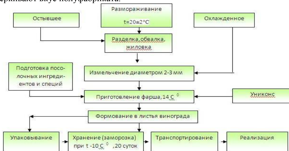
Рис.1. Технологическая схема производства замороженного полуфабриката
