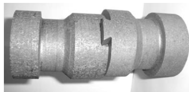
Рис. 2. Безнипельное соединение электродов
