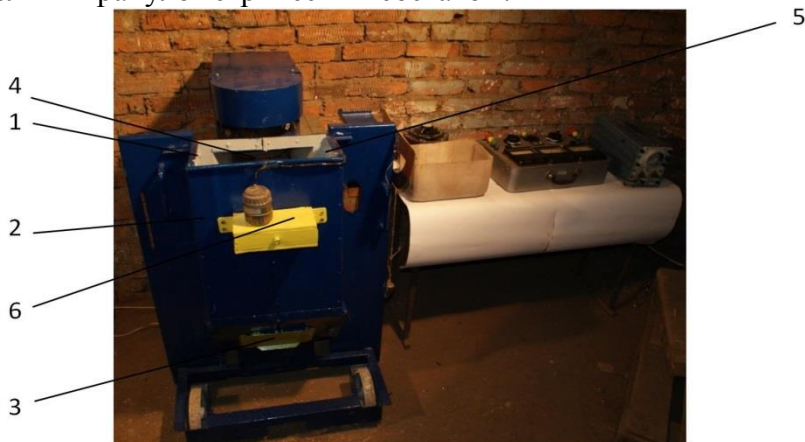
Рис. 1. Внешний вид производственного образца смесителя-обогащителя концентрированных кормов
