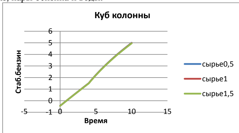
Рис. 3. Переходная кривая для расхода стабильного бензина
